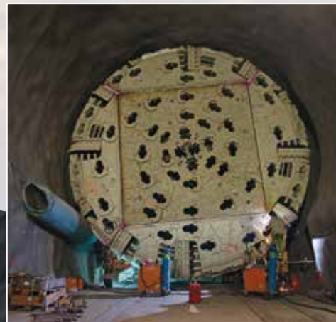
Der Bohrkopf ist der wichtigste Teil der Tunnelbohrmaschine. Beim Gotthard-Basistunnel hatte dieser einen Durchmesser von bis zu 9,58 Metern.
