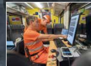
Tunnelfunksystem muss funktionieren: Tests mit dem Funkmesswagen der SBB.
