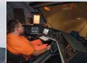
Modernste Technik: Alle Fahrbefehle werden direkt in den Führerstand der Lokomotiven übermittelt.
