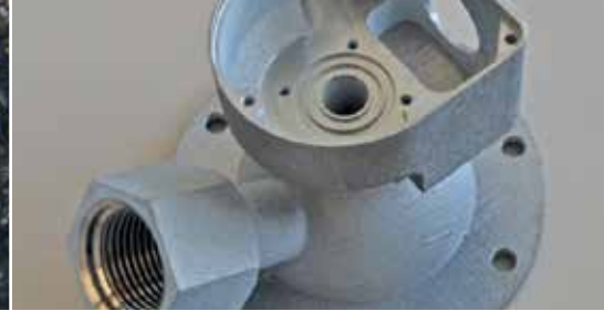
Structures et composants métalliques sortis de l'imprimante 3D: gros plan d'une sphère en grille perforée en titane (à gauche) et d'une vanne «Woov» (à droite) Source photos: ESA
