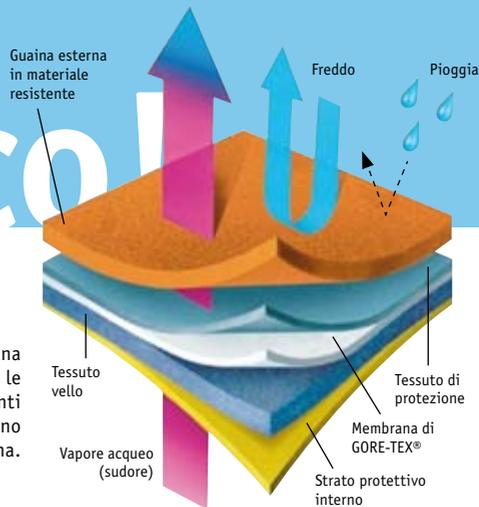
La creazione di un tessuto traspirante: l'anima del tessuto è una membrana traspirante idrorepellente, ma che lascia passare le molecole di vapore acqueo. All'interno materiali assorbenti provvedono a convogliare il sudore nella membrana. All'esterno materiali resistenti garantiscono la protezione della membrana.
