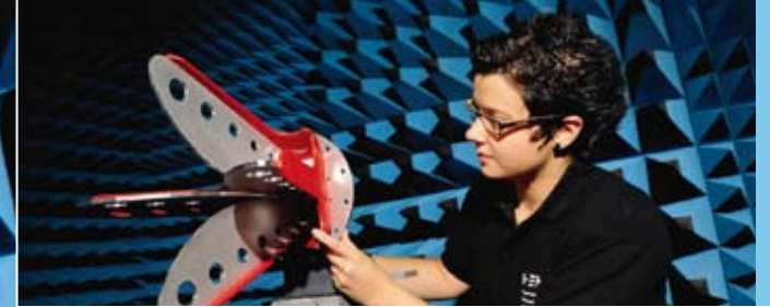
▲ L'antenna per il test commerciale viene utilizzata solo nella camera di misura e deve essere orientata in modo preciso.
