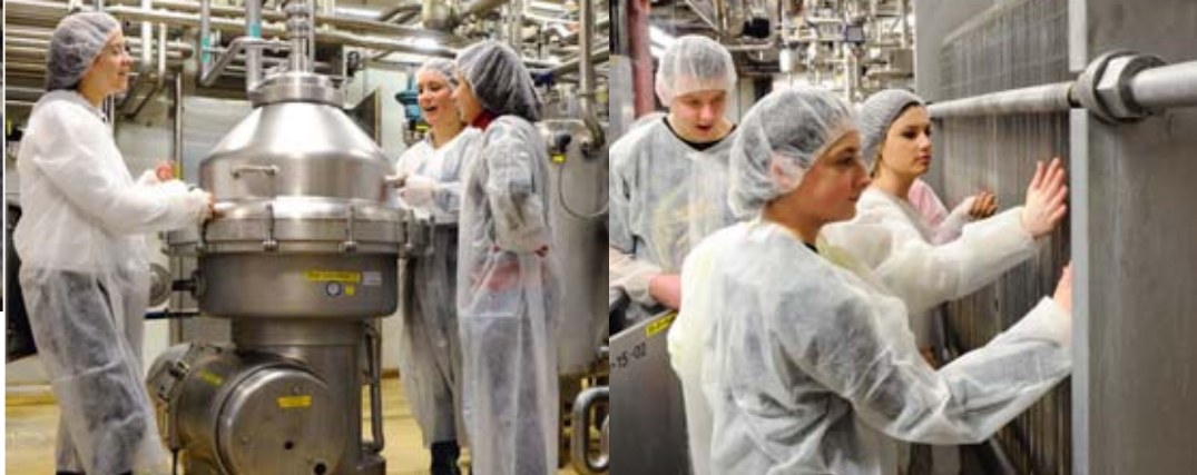
▲ Le chef d'exploitation Isidor Lauber présente les analyses de contrôle microbiologiques à une classe d'école ◀ Appareil à plaques pour la pasteurisation puis le refroidissement du lait avec importante récupération de chaleur
